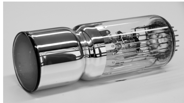
Abbildung 1: Photomultiplier mit einem Fenster für die Photonen auf der linken Seite
