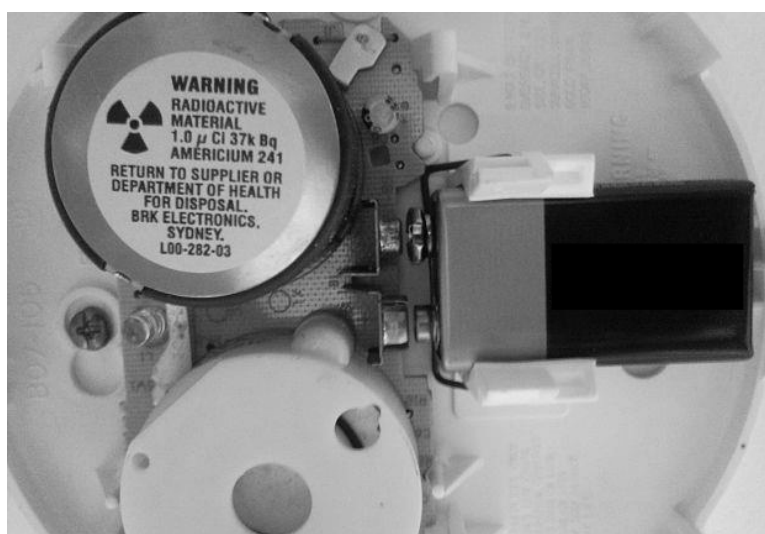
Abbildung 1: Inneres eines Ionisationsbrandmelders [1]
